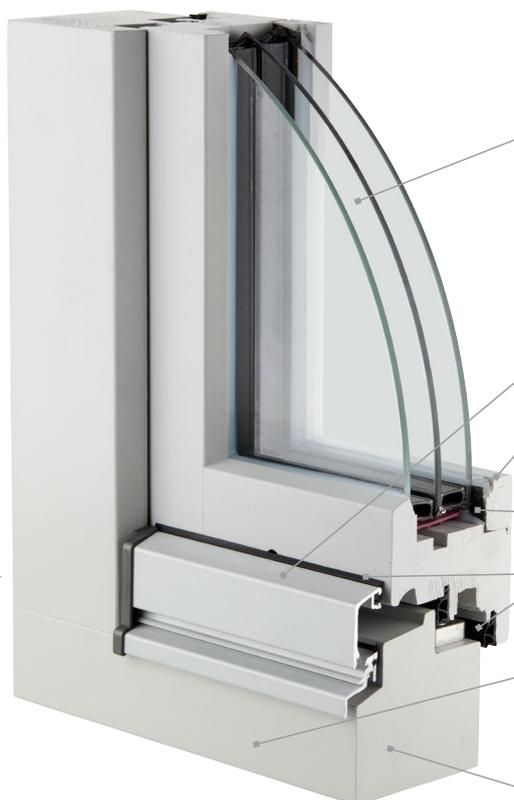
Triple Vitrage 4Fe-16-4-16-4Fe de série pour un **meilleur confort thermique et acoustique**.
